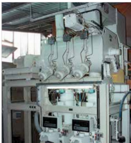
Смеситель Ploughshare® с автоматическим наполнением мешков
