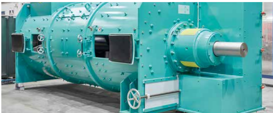
Смесители Lödige Ploughshare® для непрерывной работы: с резиновой футеровкой для защиты от износа при смешивании железной руды
