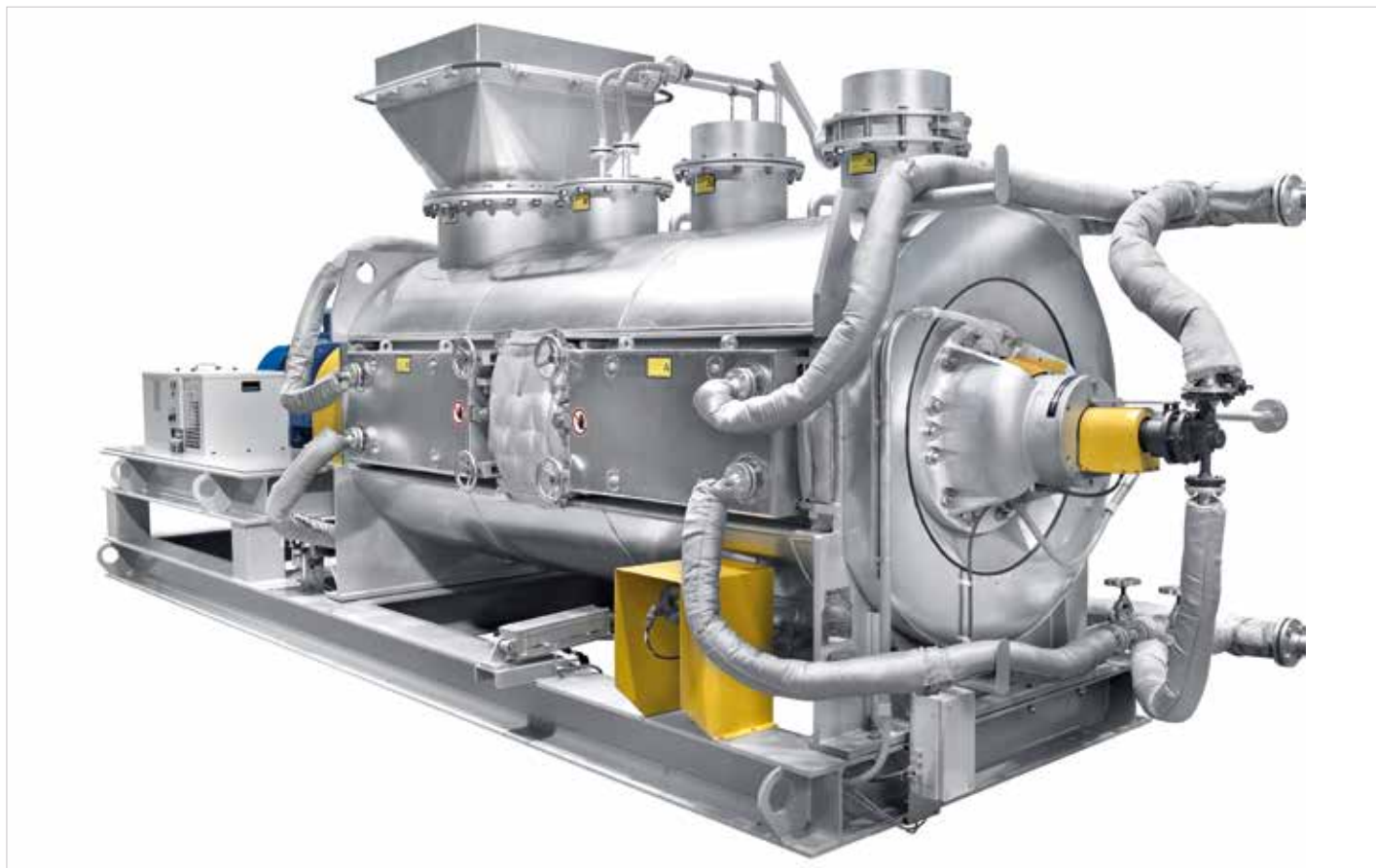
Смеситель непрерывного действия Ploughshare® для охлаждения анодной пасты
