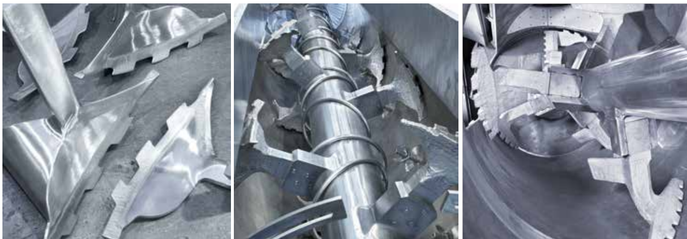
Смесительные элементы в зубчатом исполнении оптимально подходят для применения
