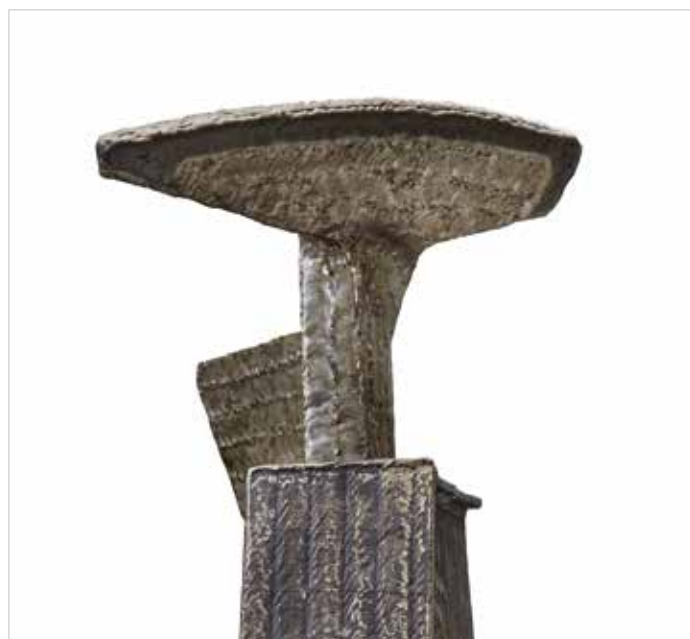
Лемех со специальным наварным покрытием из карбида вольфрама
